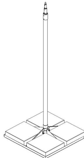
Anschlussklemme am unteren Alu-Rohr anbringen.
