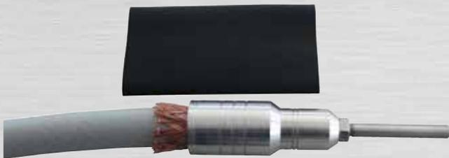
Bild 53: Positionieren des Schrumpfschlauches
