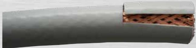
Bild 38: Abziehen des Schutzmantels
