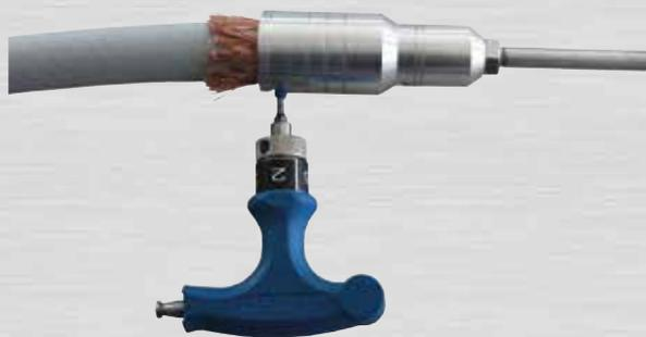
Bild 52: Gewindestift C mit 2,5 Nm anziehen
