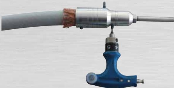
Bild 50: Gewindestift A mit 4 Nm anziehen
