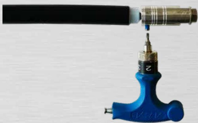
Bild 66: Gewindestift B mit 4 Nm anziehen
