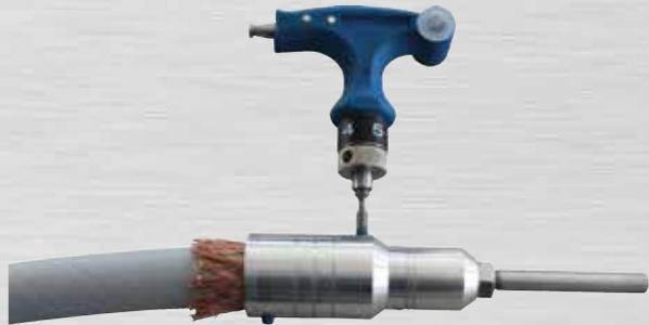
Bild 51: Gewindestift B mit 4 Nm anziehen
