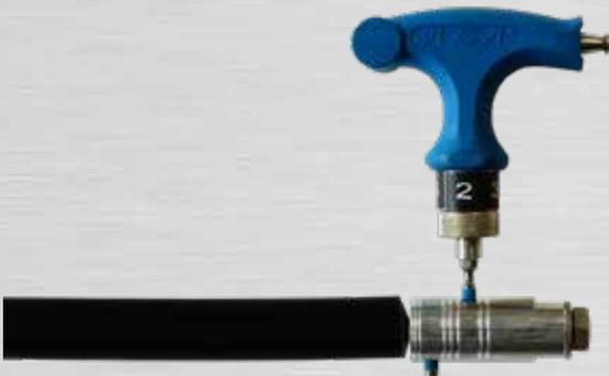
Bild 27: Gewindestift A mit 4 Nm anziehen
