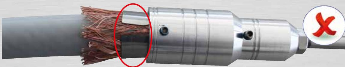
Bild 49: Falsche Positionierung von Fußstück und Kontaktblech
