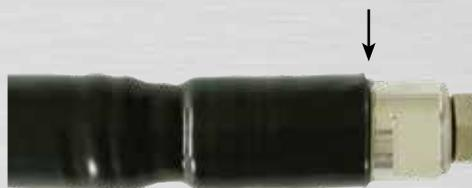
Bild 74: Gewindestifte müssen verdeckt und der Kleber ausgetreten sein
