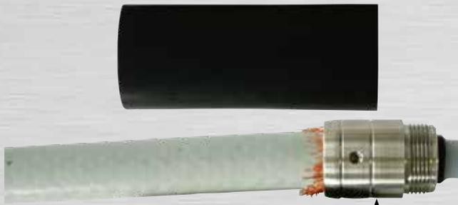
Bild 84: Angedachte Endposition des Schrumpfschlauchs (Positionsrille als Markierung)
