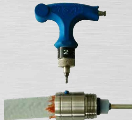
Bild 83: Gewindestift mit 4 Nm anziehen
