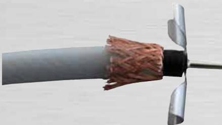
Bild 44: Aufschieben der Einzelteile
