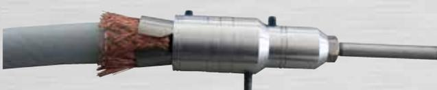
Bild 46: Aufschieben des Fußstückes
