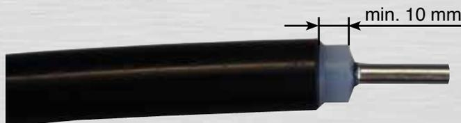
Bild 60: Abgefräste Schwarzschrift
