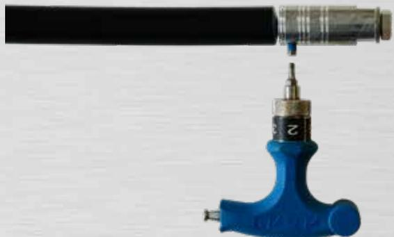
Bild 28: Gewindestift B mit 4 Nm anziehen
