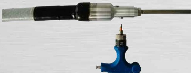
Bild 92: Zylinderkopfschraube A mit 6 Nm anziehen
