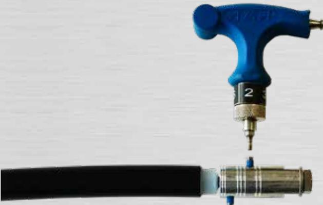
Bild 65: Gewindestift A mit 4 Nm anziehen
