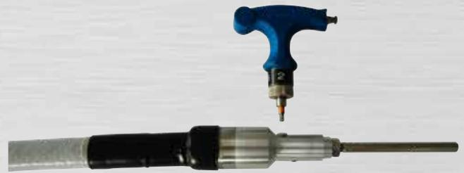
Bild 93: Zylinderkopfschraube B mit 6 Nm anziehen
