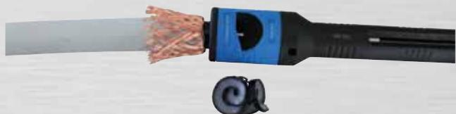
Bild 42: Abgeschälte Isolierung
