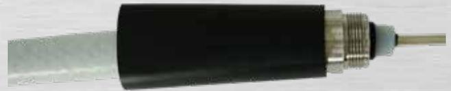
Bild 85: Aufgeschobener Schrumpfschlauch nach Bild 84
