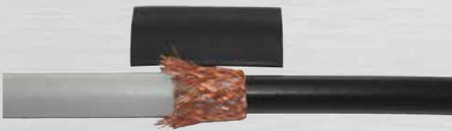
Bild 29: Positionierung des Schrumpfschlauches
