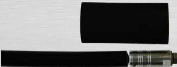
Bild 33: Positionierung des Schrumpfschlauches
